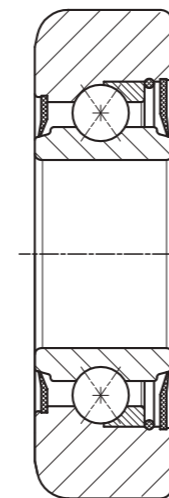
Esecuzione 2RS (Tenuta stagna) Execution 2RS (Sealed)
